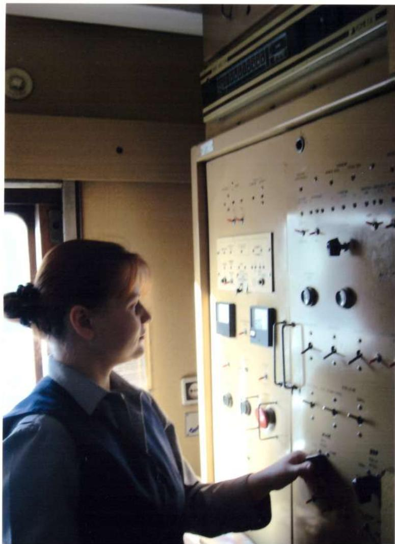
**Во время дежурства, на пульте управления следит за работой сигнализации, электроприборов (вольтметр, ампервольтметр).**
